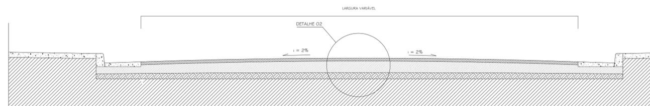
SEÇÃO TRANSVERSAL TIPO - PISTA DE ROLAMENTO - PAV. ASFÁLTICO
